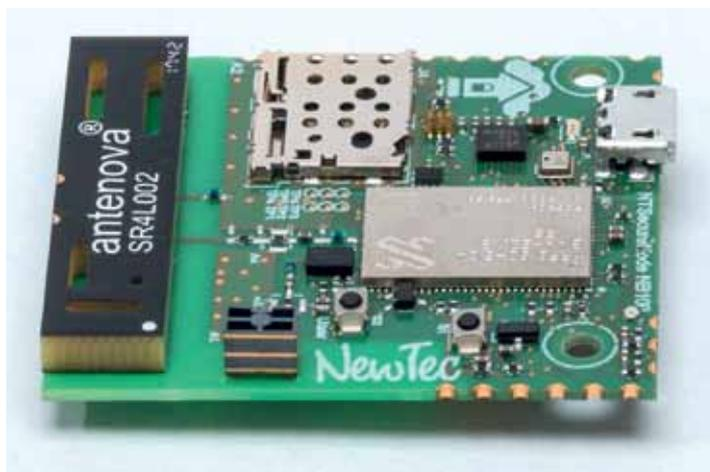
**NTSecureNode verfügt über ein spezielles Hardware-Security-Element, das es ermöglicht, besonders sensible Daten so zu verschlüsseln, dass sie sich selbst von der Cloud nicht oder nur in anonymisierter Form lesen lassen. Diese Daten sind dann nur auf dem Endgerät des entsprechenden Benutzers lesbar.**
